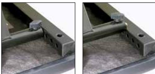
Sistema esclusivo Quik Lok di regolazione dell'altezza. La panchetta BX/718 usa un sistema di bloccaggio robusto, con un doppio binario in acciaio e due perni a molla su ogni gamba per regolazioni in altezza salde e sicure. Semplicemente allentate le viti di blocco, premete assieme i perni a molla, fate scorrere le gambe ad una delle quattro posizioni d'altezza, i perni scattano all'interno delle sedi e quindi stringete e bloccate le viti.
